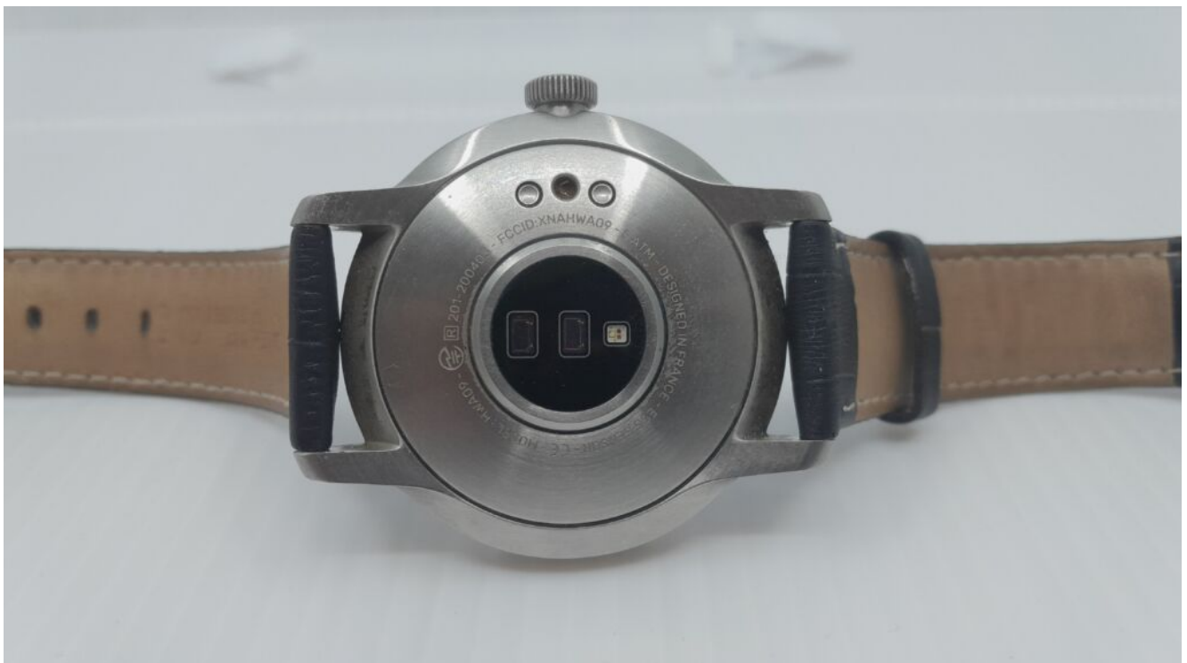
Kuva 2. Sykettä ja happisaturaatiota mittaavat optiset anturit ovat kellon pohjassa. Yhdessä PPG, SpO2 ja kiihtyvyyssanturin kanssa kellolla mitataan unen laatua ja mahdollisia hengityshäiriöitä (kuva: Panu Weckman, 2024).
