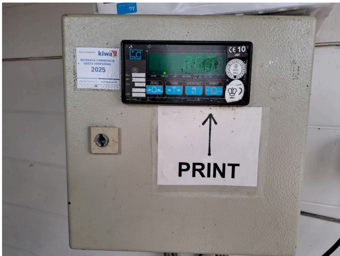
Kuva 1. Hajatek Oy:n käytössä oleva HBM WE2110 -vaakajärjestelmä (kuva: Saku Kaarlejärvi).
