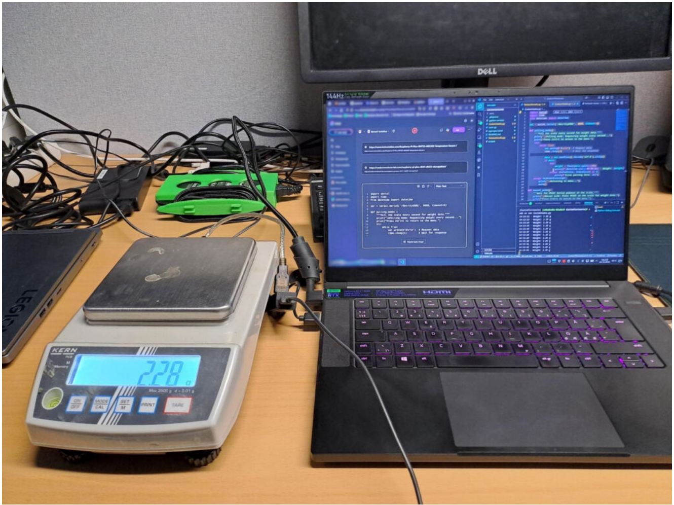
Kuva 2. Punnitustiedon lukemista testattiin Python-ympäristössä laboratoriovaa'an avulla (kuva: Saku Kaarlejärvi).
