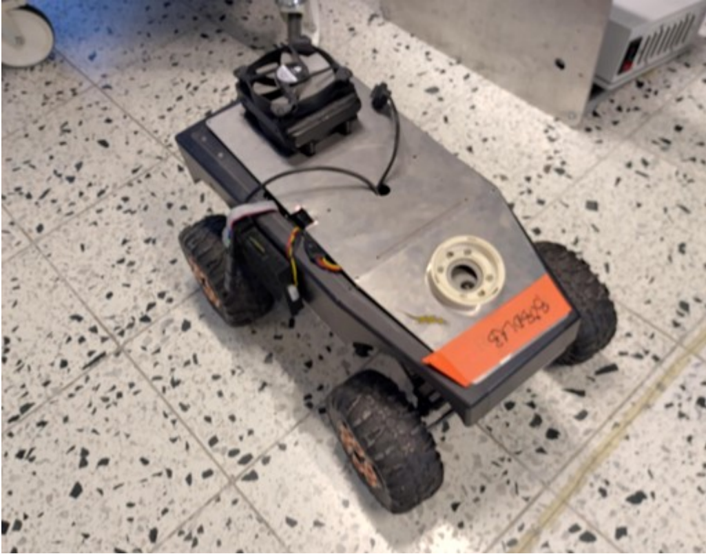
Robolabissa opiskelijakäytössä oleva RC-auton rungolle rakennettu mobiilirobottialusta (kuva: Tommi Ylimäki).
