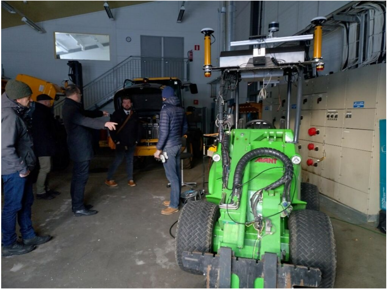
Jukka Yrjänäinen esittelee Mobiilihydrauliikan laboratorion kalustoa. Etualalla autonomiseen toimintaan varusteltu Avant-pienoiskuormaaja jota on hyödynnetty tutkimusallustana jo vuodesta 2012 (kuva: Tommi Ylimäki).
