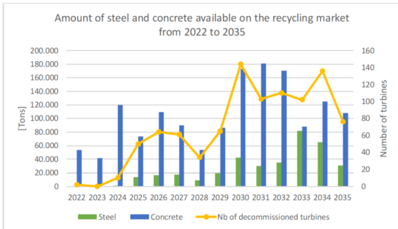
Kuva 5. Teräksen ja betonin määrä purettavista tuulimyllyistä Belgian flaamilaisella alueella (kuva: Biowind-hankkeen workshop, tutkimusraportti).
