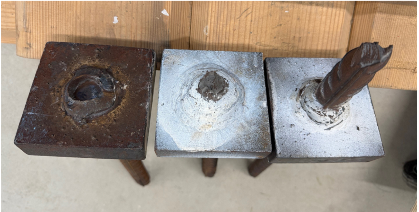
Kuva 1. a) Liian alhaisella virralla hitsattu kylmä liitos, b) Liian suurella virralla hitsattu kuumahauras liitos, c) Sopivalla virralla hitsattu liitos, katkeaa vedossa selvästi yksinomaan perusaineen puolelta (kuva: Jorma Tuomisto, 2025).
