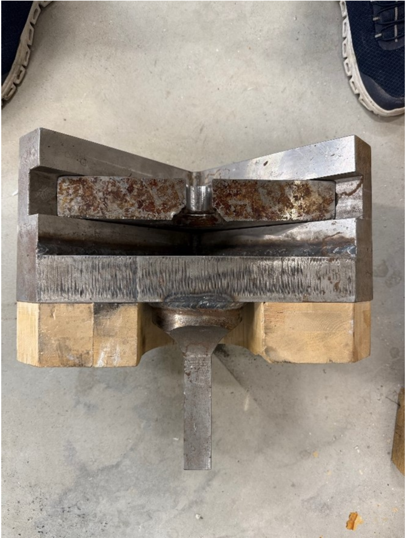
Kuva 3. Kiinnityslevyn levyn puoleinen (ala)pää kiinnitetään testissä tällaiseen apuvälineeseen. Apuvälineen alapää kiinnitetään vetokojeen leukojen väliin (kuva: Jorma Tuomisto, 2025).
