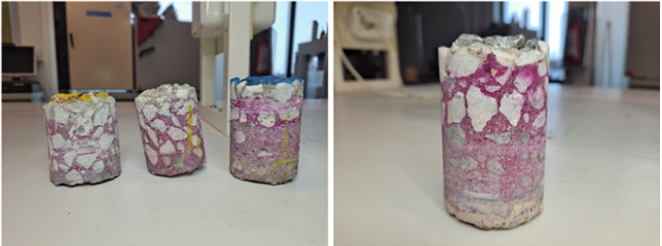
Kuva 2. Vasemmassa kuvassa vanhan osan poranäytteet ja oikeassa kuvassa uuden osan vertailukappale (kuva: Veli Autio, 2025).
