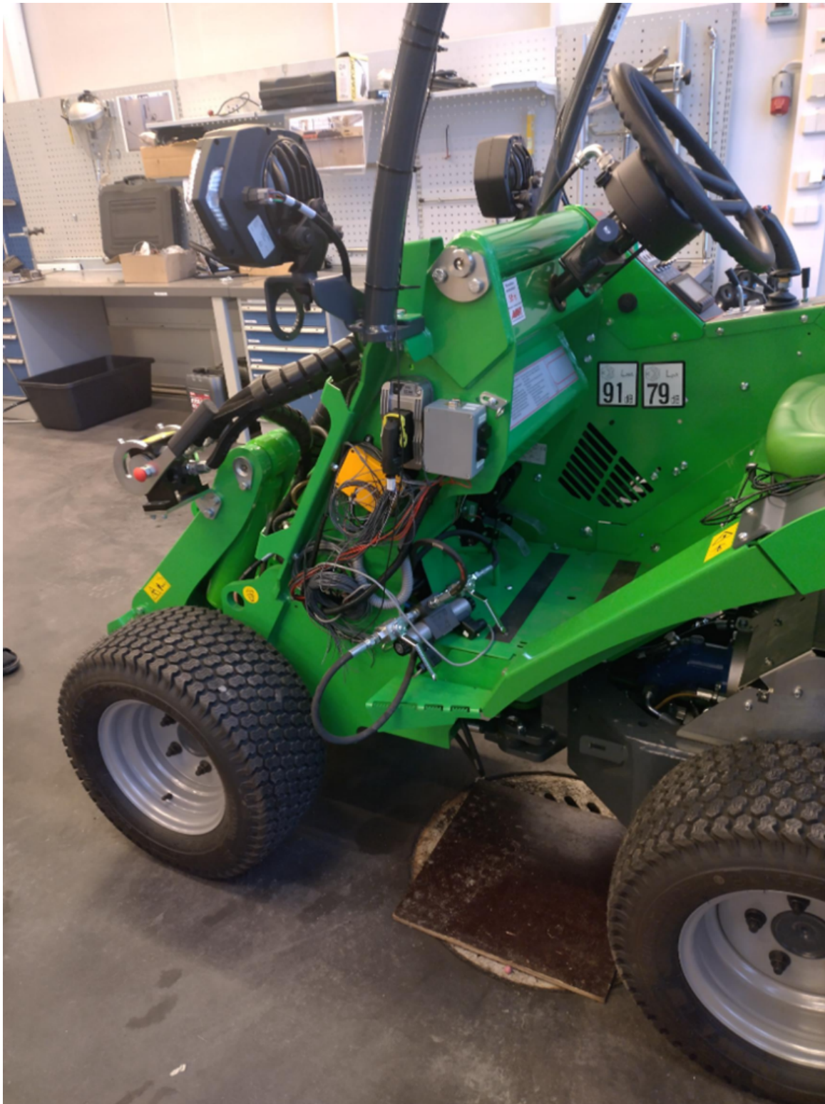
Kuva 2. Sähköisen Avant e6 pienoiskuormaimen hallintalaitteiden rinnalle TAMKissa rakennettu kaukokäytön mahdollistava laitteisto (kuva: Tommi Ylimäki).
