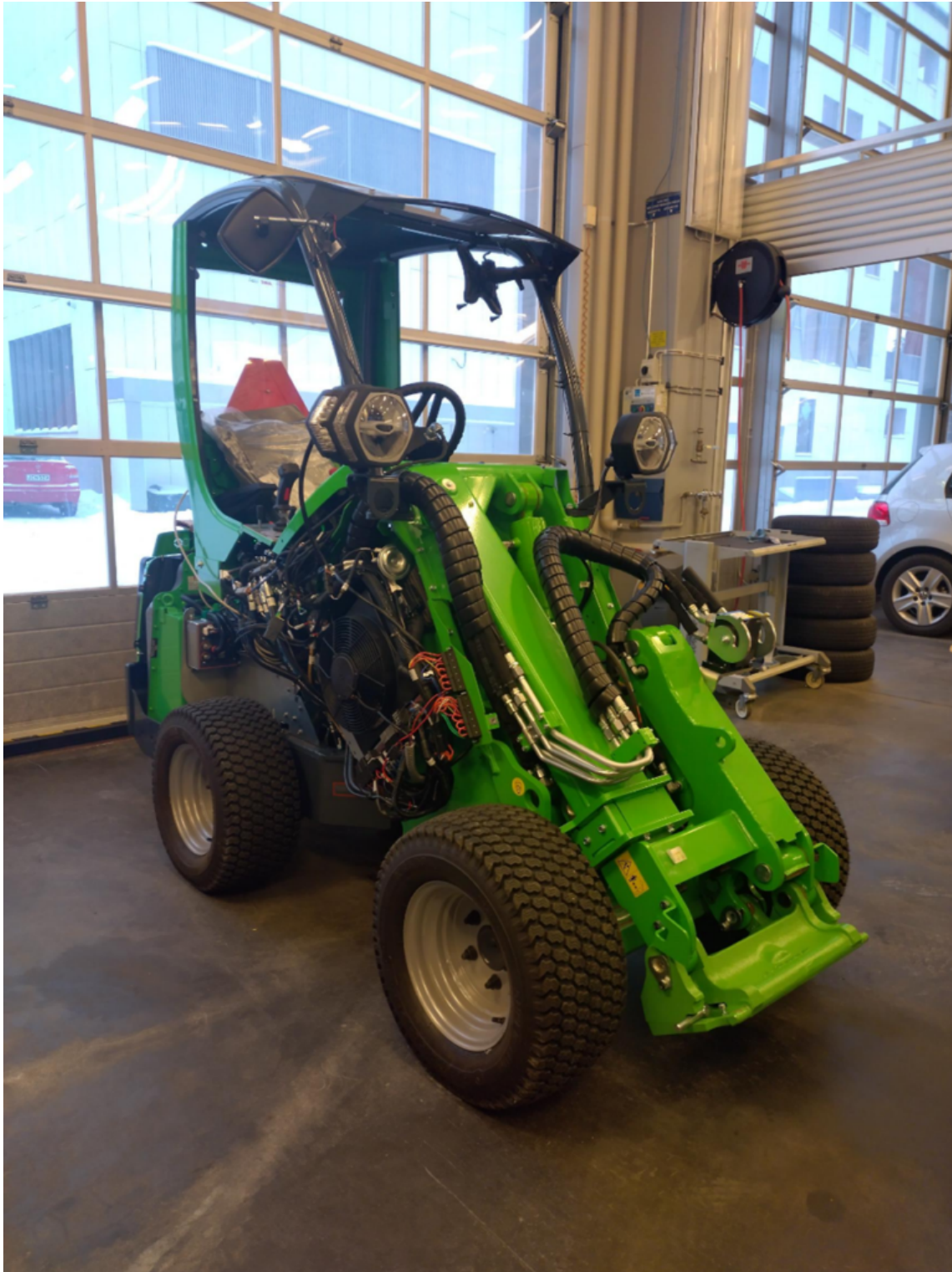
Kuva 1. TAMKin eSmart Machines hankkeessa investoitu sähköinen Avant e6 pienoiskuormaaja (kuva: Tommi Ylimäki).
