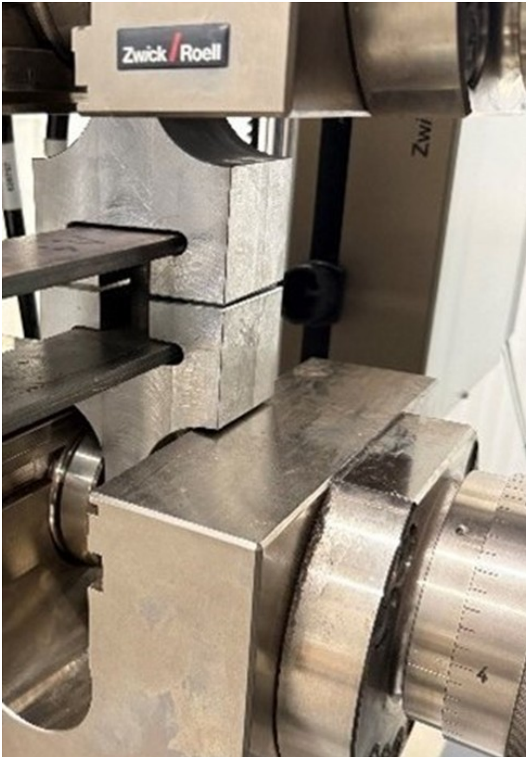
Kuva 2. Robottihitsatun komponentin vetokoetestausta (Jorma Tuomisto, 2026).
