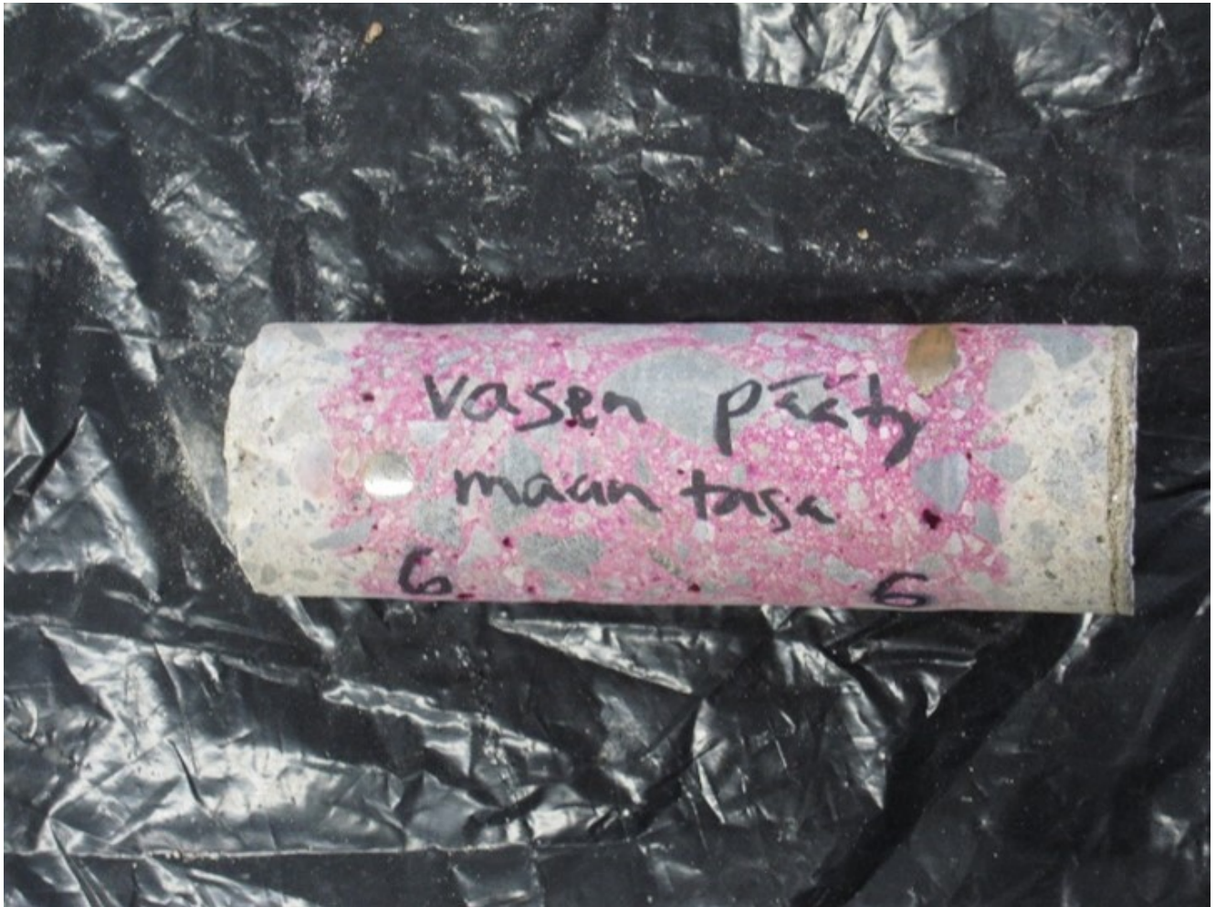
Kuva 3. Karbonatisoitumistesti. Kuvituskuva, ei liity oheiseen projektiin (kuva Jorma Tuomisto, 2024).
