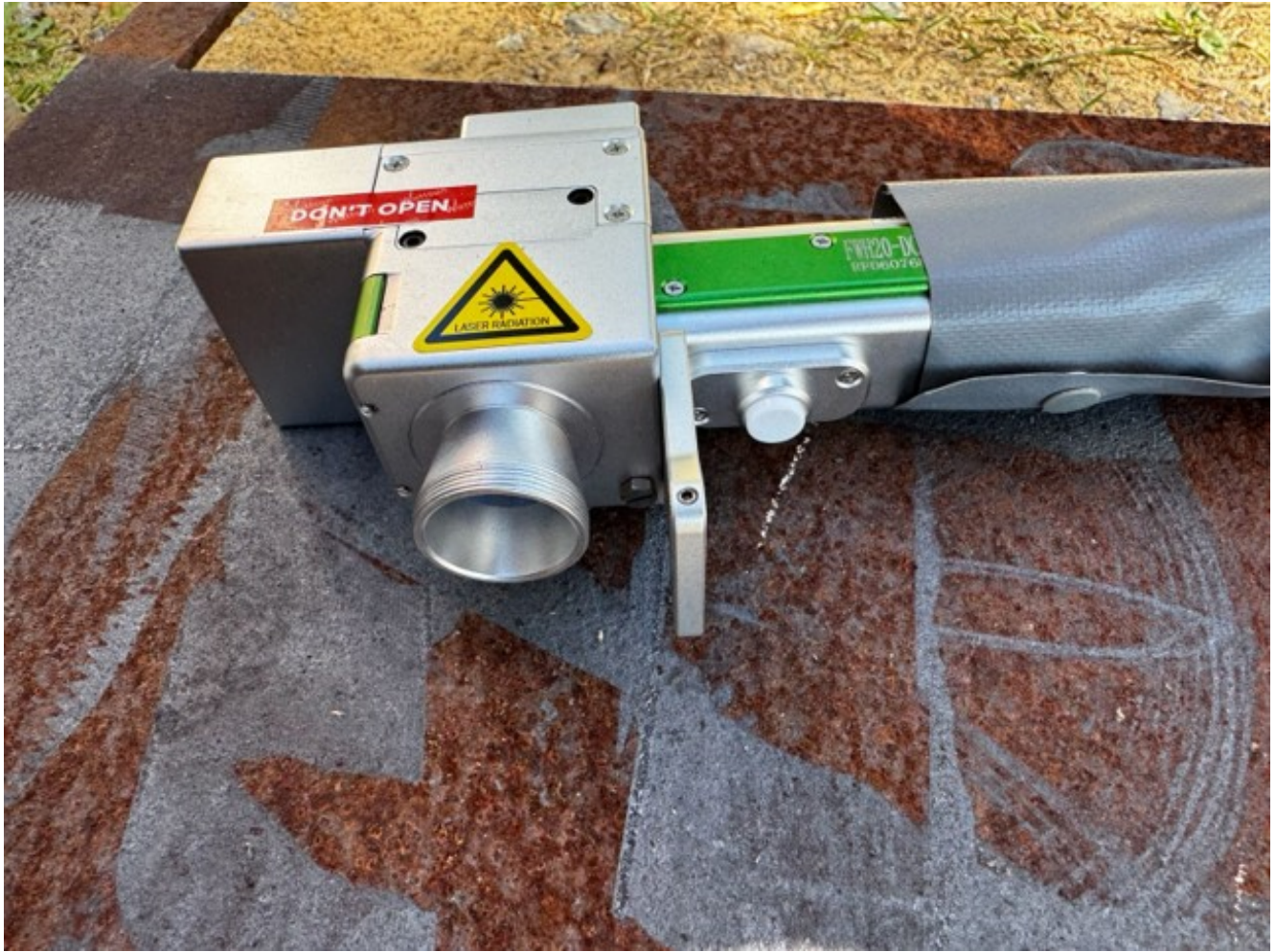
Työssä käytetty Wattsan-laserin työstöpää (kuva: Tia Kraft, 2026)
