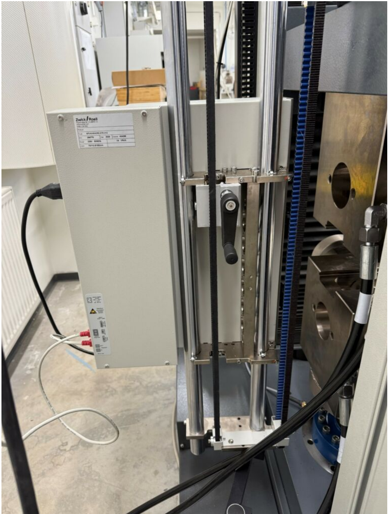
Kuva 2. Näytteestä venymää suoraan mittaava mekaaninen extensometri sijaitsee laitteen takana. Varsinaiset mittahaarukat eivät ole paikoillaan, vaan ne kiinnitetään testin yhteydessä erikseen laitteeseen (kuva: Jorma Tuomisto, 2025).
