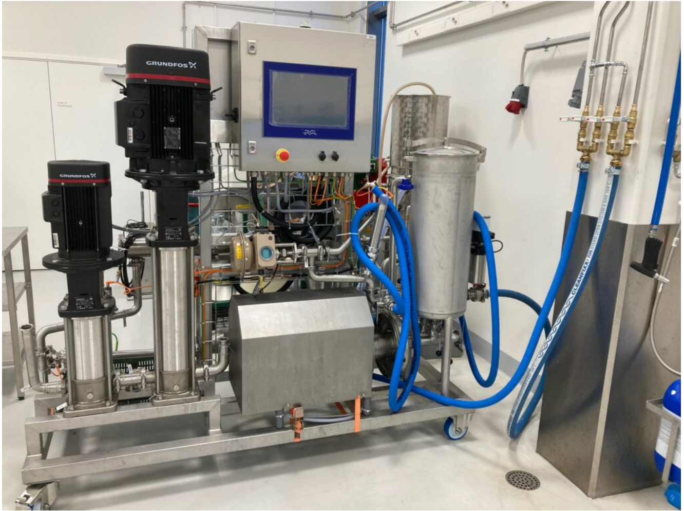
Kuva 1. Alfa Laval PilotUnit Multi -membraanisudatuslaitteisto (kuva: Alisa Ala-Huikku, 2024).
