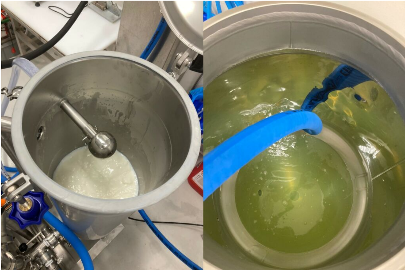
Kuva 3. Retentaatti ja permeaatti (kuva: Alisa Ala-Huikku, 2024).
