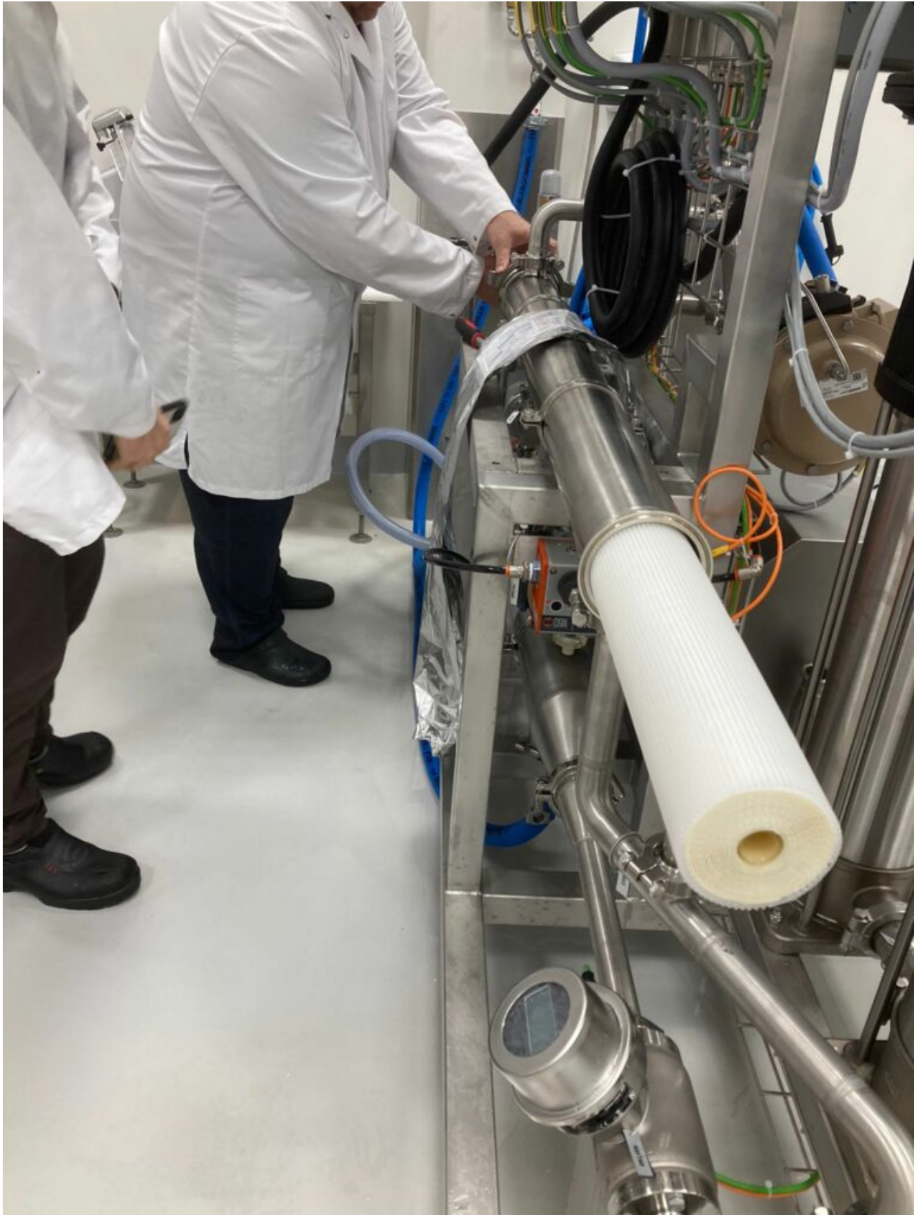
Kuva 2. Membraanisudatuslaitteiston sudatusyksikkö ja spiraalimembraani (kuva: Alisa Ala-Huikku, 2024).
