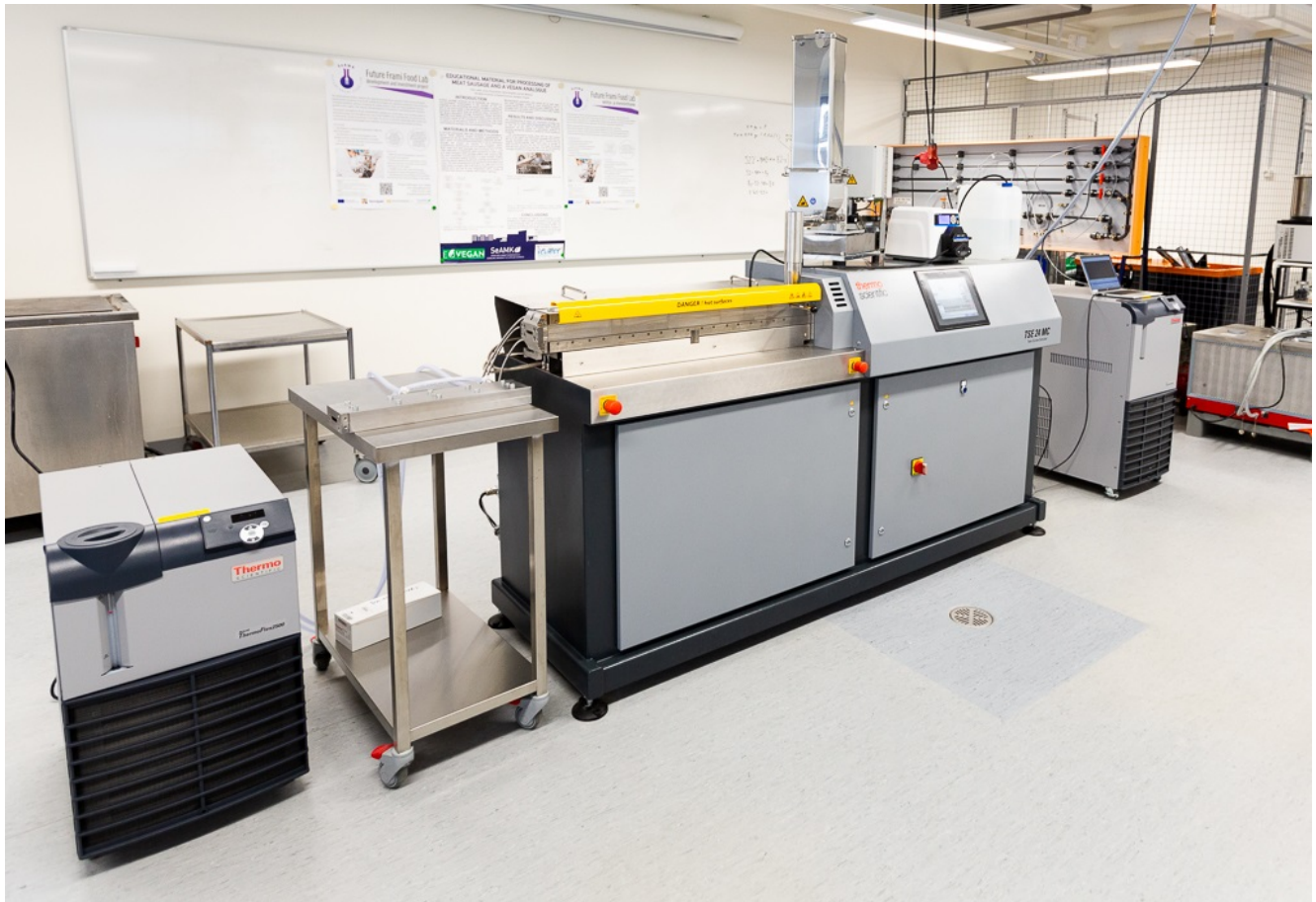
Kuva 1 . Thermo Scientific TSE 24 MC –kaksoisruuviekstruuder (kuva: Matti Leppälehto, 2024).
