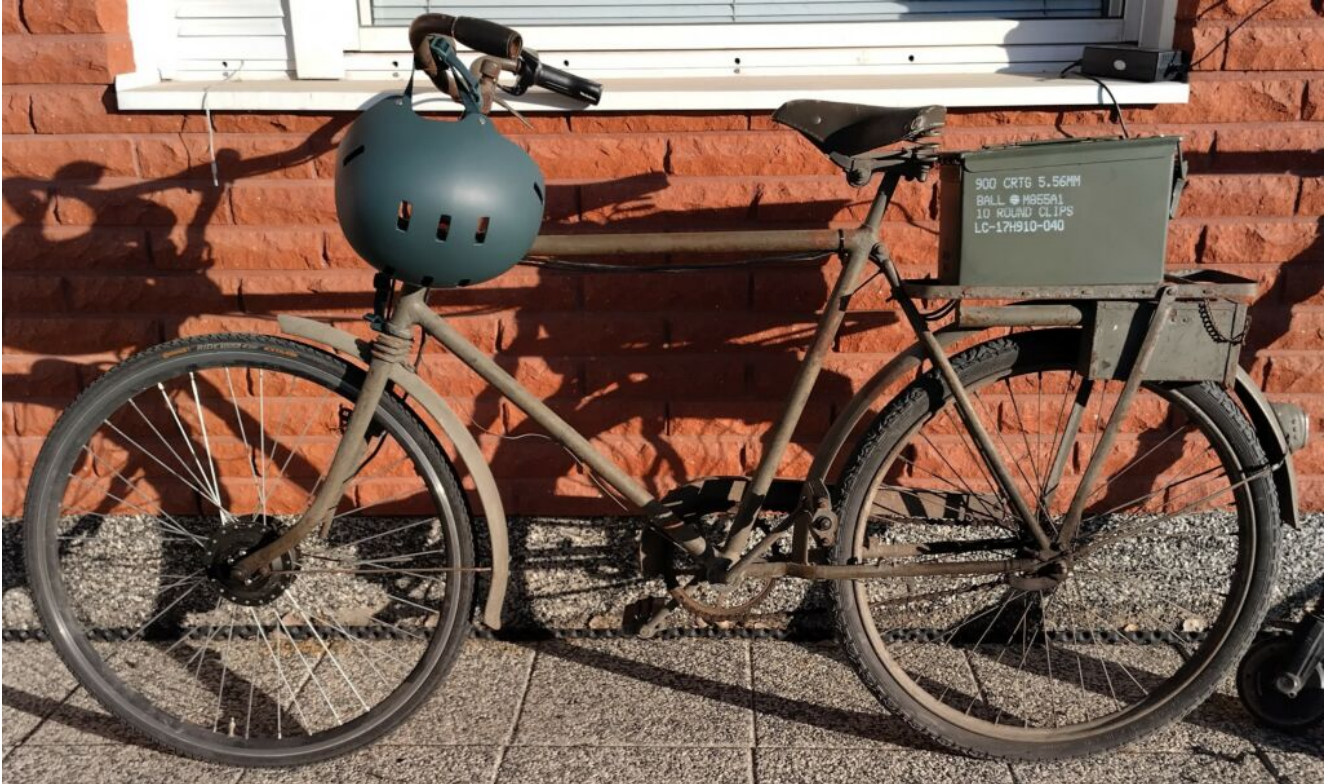
Kuva 1. Vanha armeijan polkupyörä sähköistetty hyödyntäen sähköistyssarjaa (kuva: Jukka Mattila, 2024).
