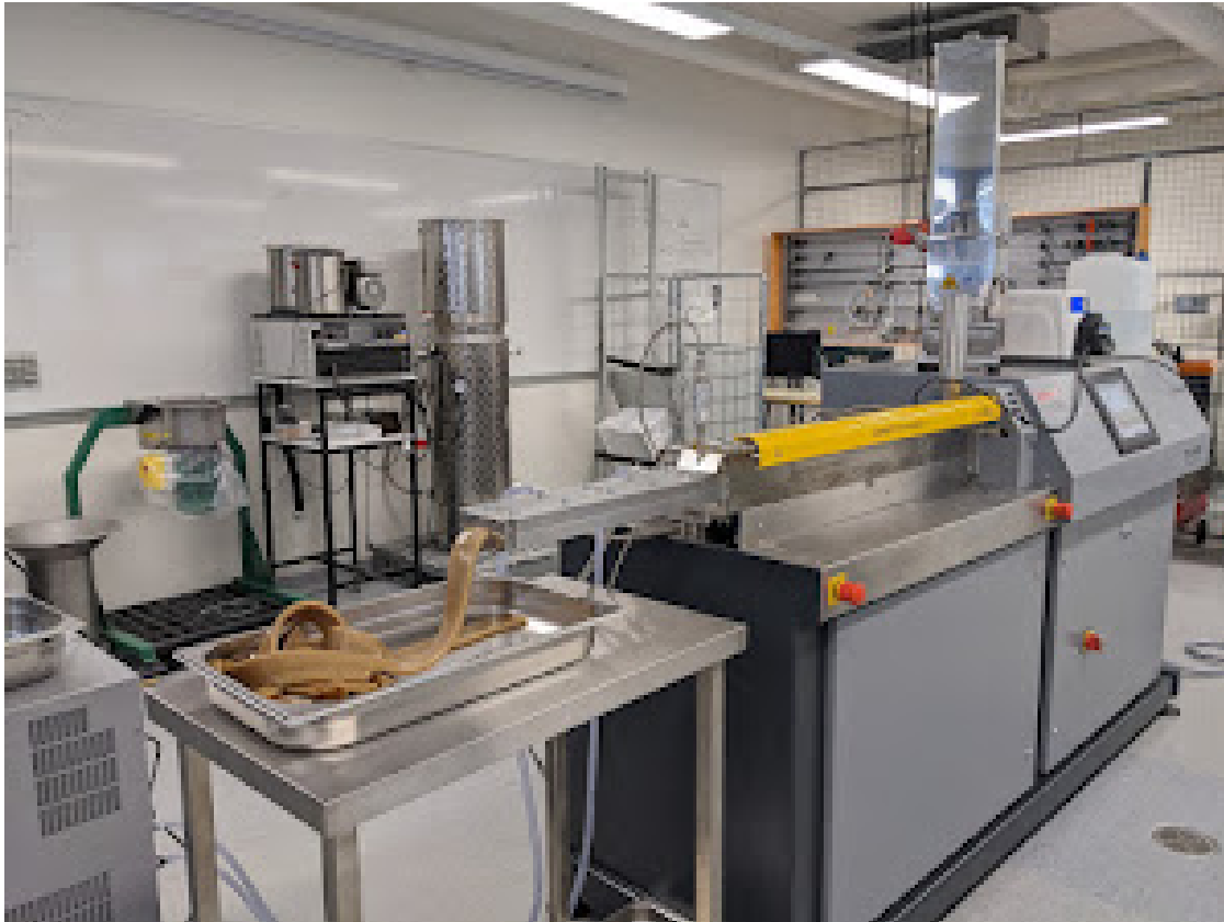
Kuva 2. Thermo Scientific TSE 24 MC –kaksoisruuviekstruuder (kuva: Matti Leppälehto).
