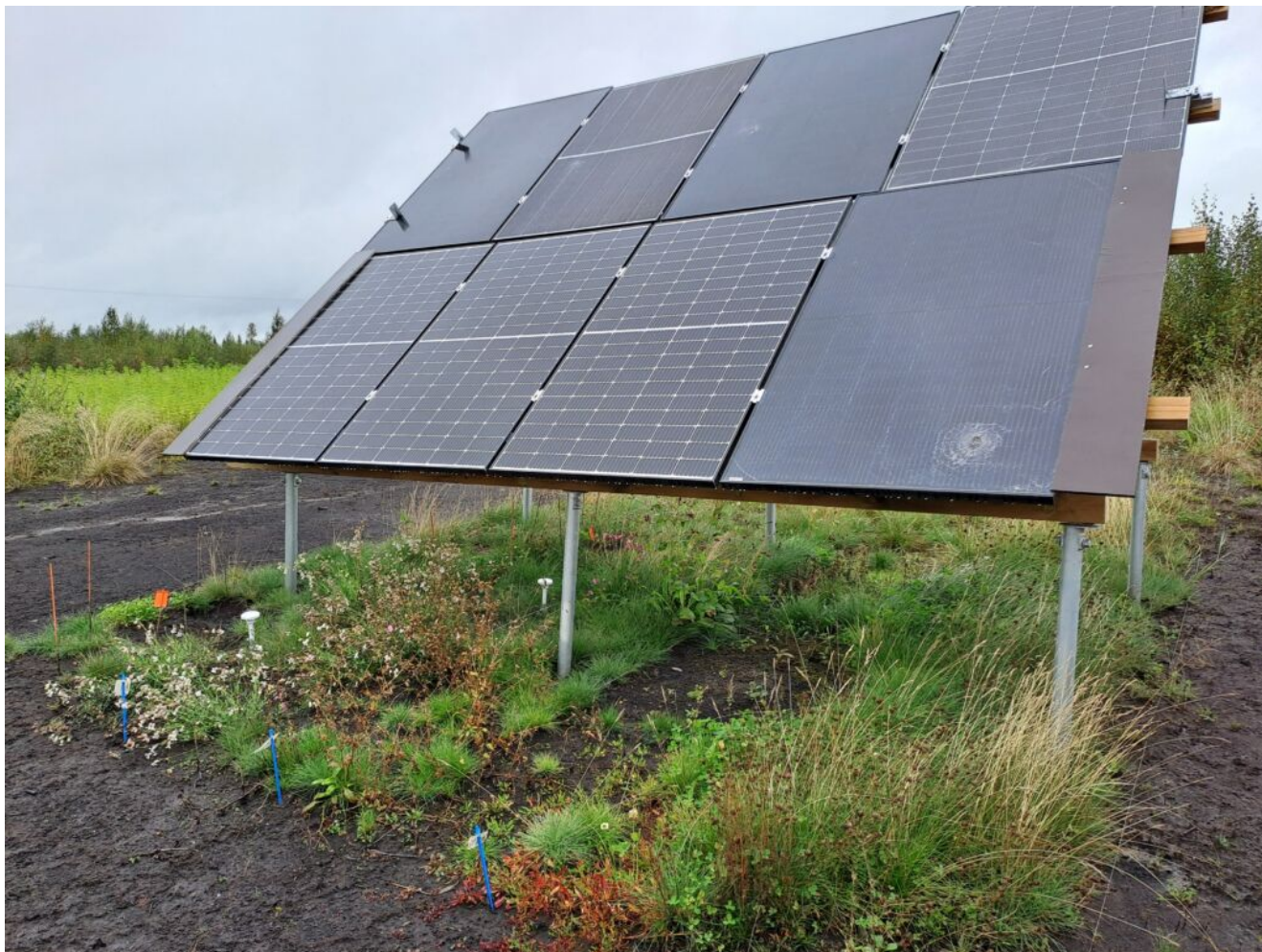
Kuva 1. Aurinkosuo-hankkeen koeasetelmaa Lantonsuolla Lapinlahdella. Hanke on saanut käyttöön käytöstä poistuneita rikkiäisiä aurinkopaneeleita, joiden alle on perustettu kasvillisuuskoeruutuja (kuva: Kari Laasasenaho).
