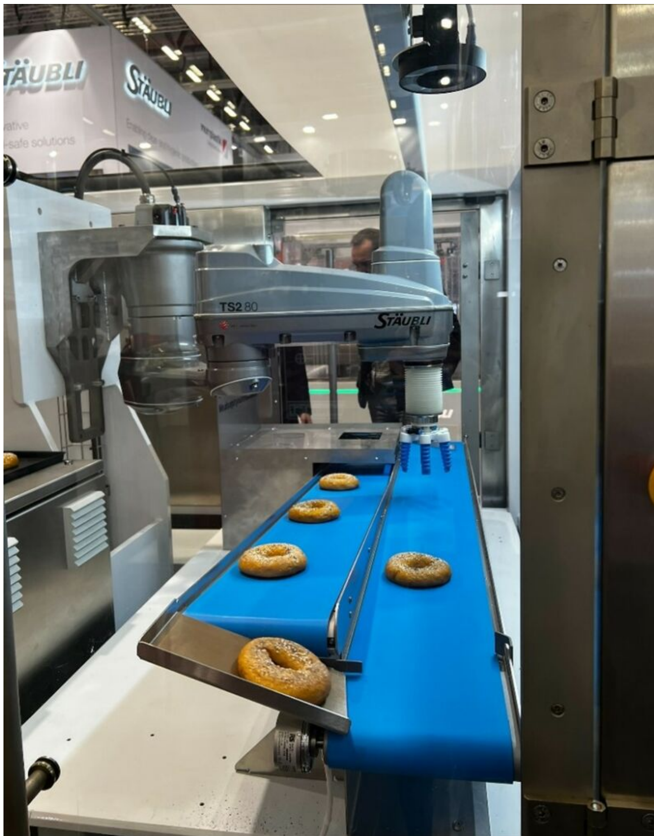
Stäublin SCARA-robotti bagel-tuotteiden lajitteluun (kuva: Krista Eteläkari).
