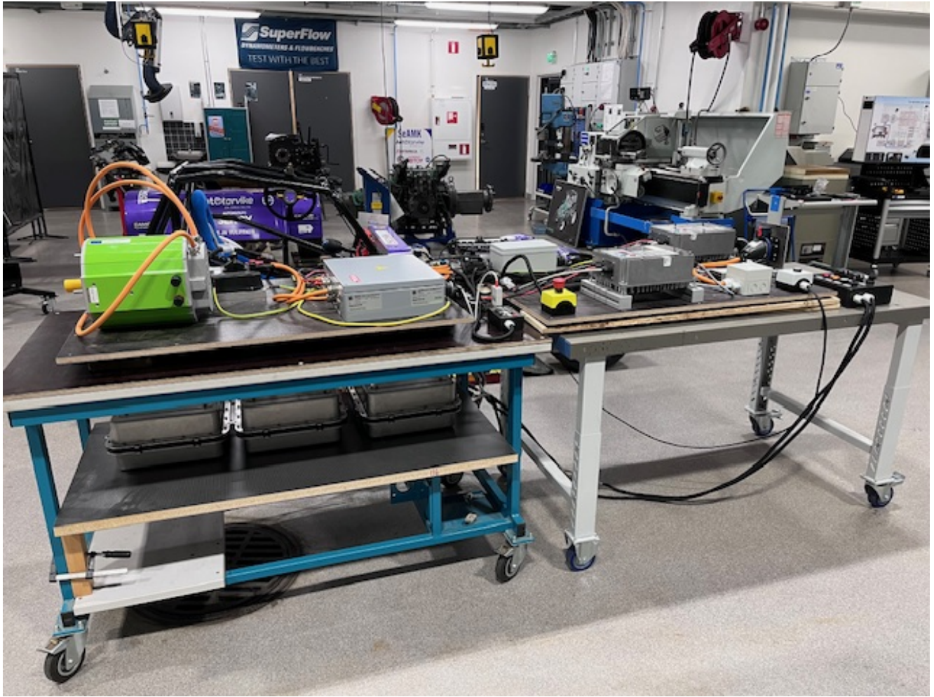
Kuva 1. Laboratorioon hankittu sähköisen voimalinjan simulaattori. Oikealta vasemmalle moottori, invertteri, tehonjakoyksikkö, laturit ja hallintapaneeli. Ohjausyksikkö piilossa etuvasemmalla ja akut pöydän alla oikealla (kuva: Juha Vaara, 2025).
