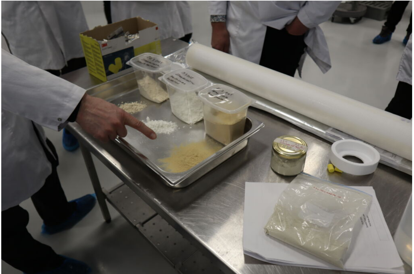
Kuva 7. Erilaisia SiccaDanian SD900-SS-spraykuivaimella kuivattuja jauheita sekä Alfa Lavalin PilotUnit Multi-membraanisuodatuslaitteessa käytettävä suodatuskalvo (kuva: Jasmine Laitila, 2025).
