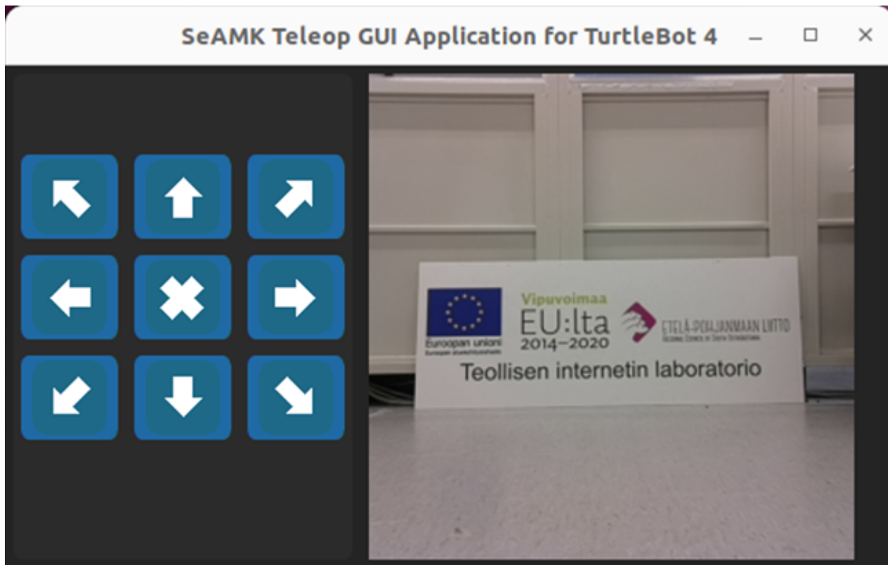
Kuva 5. Autonomiset ajoneuvot hankkeessa kehitetty kevyt graafinen käyttöliittymä TurtleBot-mobiilirobotille. Käyttöliittymä näyttää reaaliaikaisen videokuvan robotilta (Kuva: Hannu Hakalahti 2024).
