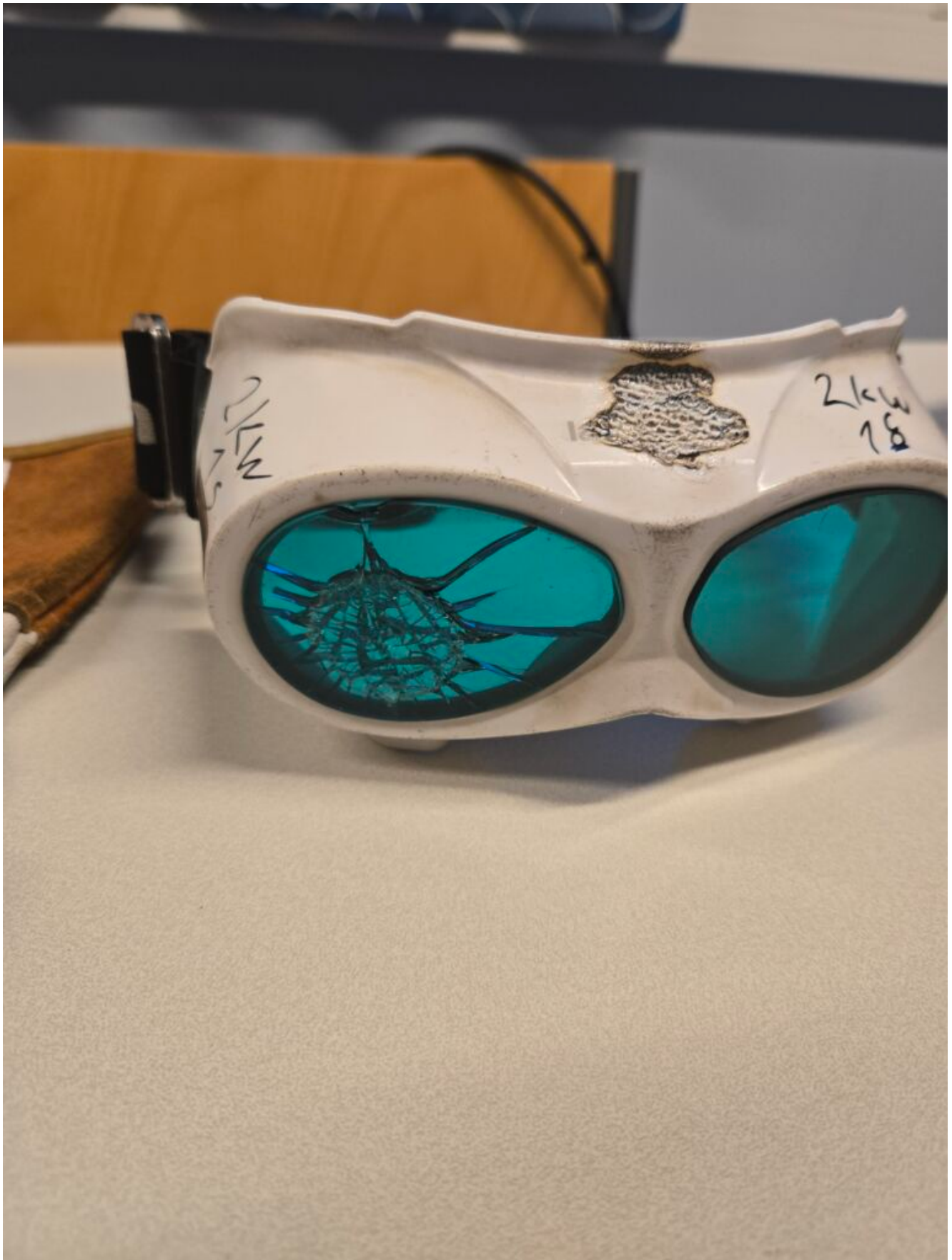
Kuva 1. Lasersäteen vaikutukset suojalaseihin 2kW teholla 1 sekunnin ajan (Testannut: Piironen Aki, Turun yliopisto).
