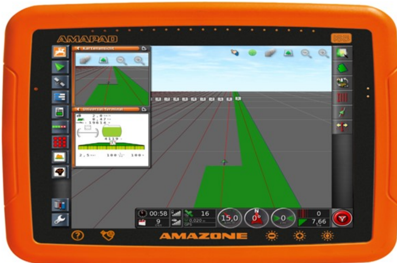
Kuva 1. Kosketusperiaatteella toimiva näyttö (terminaali) maalaa ruiskutusjälkeä. Tällainen näyttö voi olla kiinteä osa traktoria tai usein myös työkonteen mukana tuleva, kuten kuvassa oleva. (Kuva: Amazone nettisivut.)
