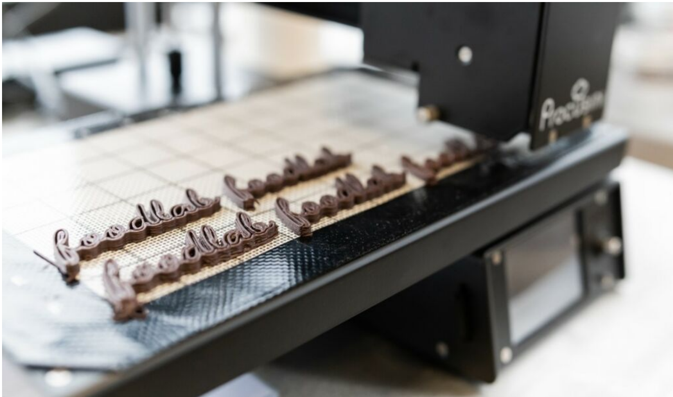
Kuva 2. 3D-printteri on tulostamassa suklaasta erilaisia tuotteita (Kuva: Arthur Isaak).
