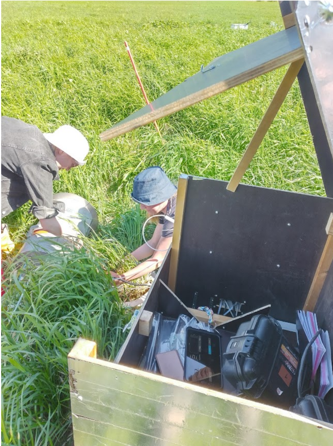
Kuva 4. Viikin agronomiopiskelijoita suorittamassa kasvihuonekaasumittauksia uudella liikuteltavalla laitteistolla monivuotisella nurmikasvustolla (Kuva: Kari Laasasenaho).
