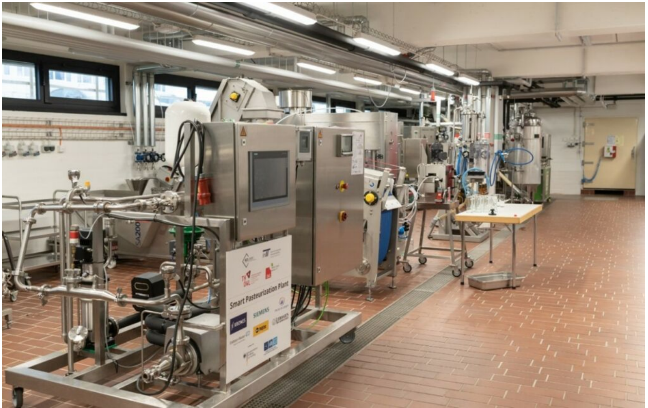
Kuva 2. Kuvassa juomateknologian uusi älykäs pastöintipilotti, joka on valmistettu yhteistyössä alueen teollisten yritysten kanssa (Kuva: Arthur Isaak).
