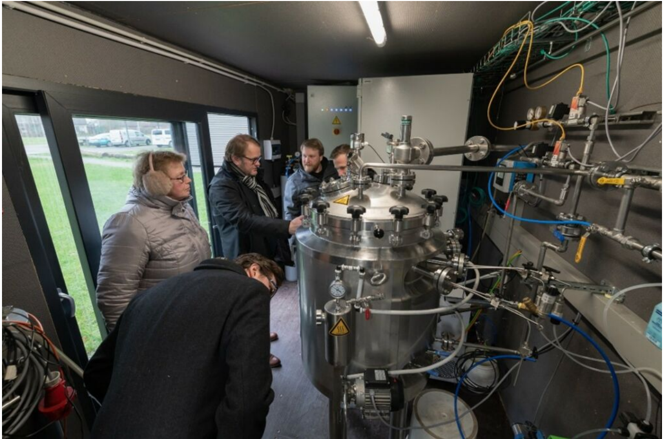
Kuva 2. Jatkuvatoimiseen sekoittimella varustettuun reaktoriin syötetään elatusaineeksi vetyä ja hiilidioksia Methanothermobacter marburgensis –bakteerille. Bakteeri on termofiilinen ja optimilämpötila bioreaktorissa on noin 60 °C. Reaktori toimii 5 baarin paineessa. Gun Wirtanen, Karri Kallio, Jarmo Alarinta syventyivät reaktoritekniikkaan Timo Broekerin opastuksella (Kuva: Arthur Isaak).
