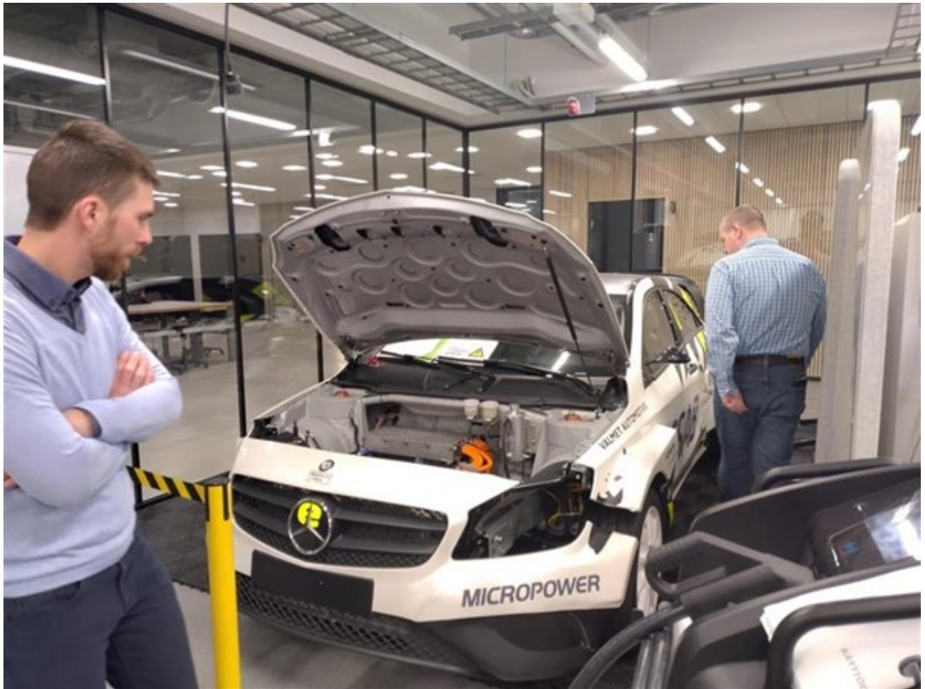
Käytettynä hankitusta A Mercedeksestä projektien ja projektiopintojen voimin on rakennettu eRallycross-auto (kuva: Tommi Ylimäki).
