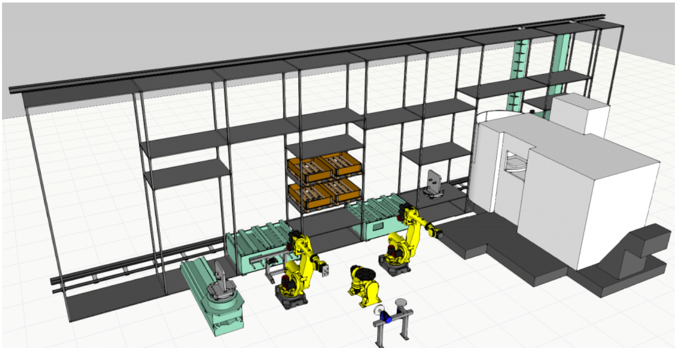
Kuva 2: Konetekniikan laboratorion FMS-solun digitaalinen kaksonen
