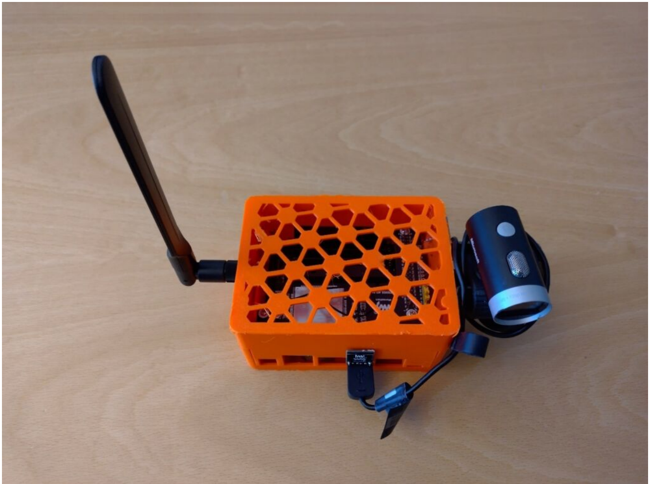
Kuva 1. Jetson Nano ja LTE-kortti 3d-tulostetussa kuoressa. Laitteeseen on liitetty erillinen USB-kamera sekä LTE-kortin antenni (kuva: Tommi Ylimäki).
