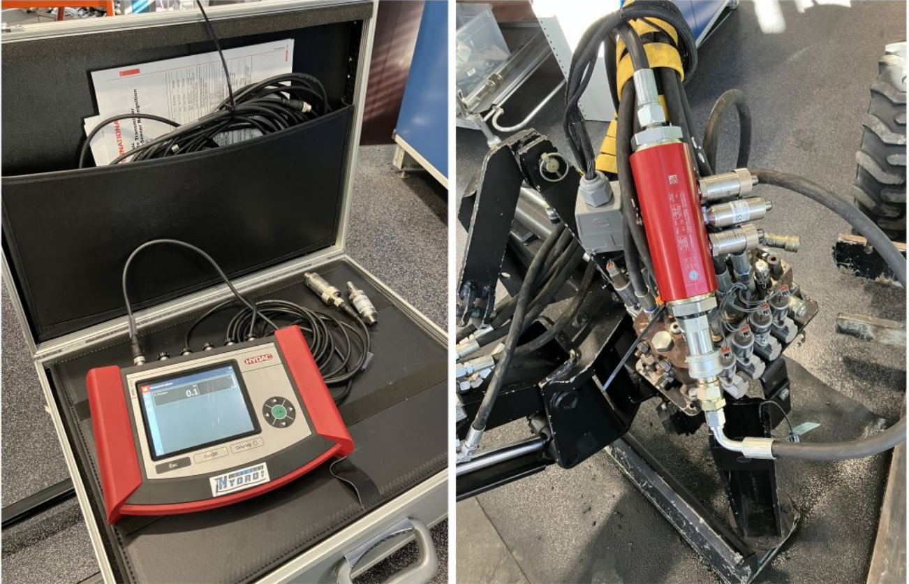
Kuva 2. Vasemmanpuoleisessa kuvassa paineanturi kytkettynä käsimittalaitteeseen ilmanpaineessa. Oikealla puolella virtausanturi kytkettynä kaivuubarren venttiililohkon painelinjaan (Mäkitalo, 2023).
