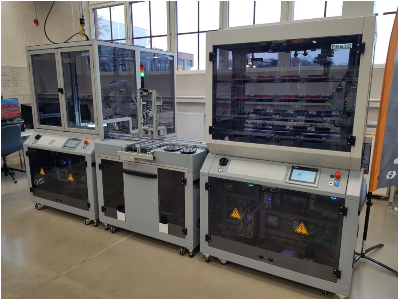
Kuva 1. SeAMKin teollisen internetin laboratorion "fysikaalinen kaksonen" eli Mälardalenin teknologiakeskuksen linja.
